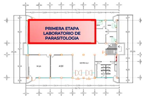
**Figura 79.** Construcción de la primera etapa 193 m<sup>2</sup>, incluye: solo el Laboratorio de Parasitología 6 entre ejes
